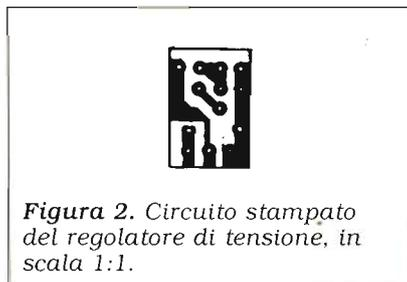
Figura 2. Circuito stampato del regolatore di tensione, in scala 1:1.
