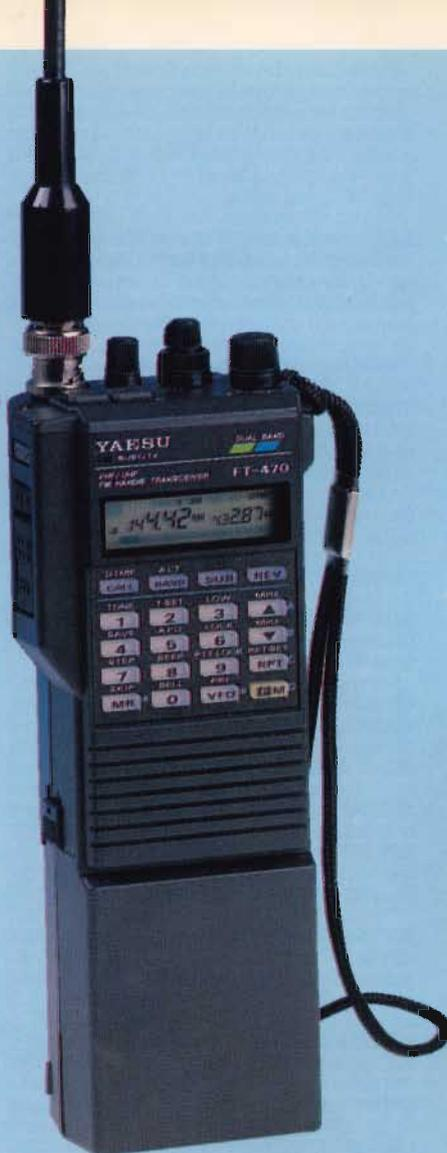
Costituisce un balzo aggiuntivo verso la miniaturizzazione integrale e la riduzione sui consumi senza alcun detrimento alle caratteristiche operative. L'ossatura dell'apparato é realizzata in alluminio raggiungendo pregevoli caratteristiche di schermatura e solidità.
